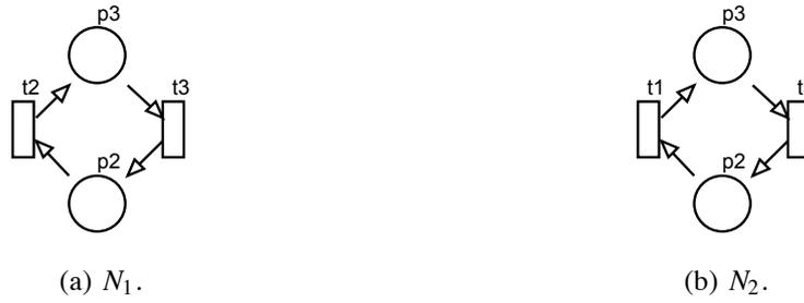
**Figura 6.17** Renomeando a transição  $t2$  para  $t1$ .
