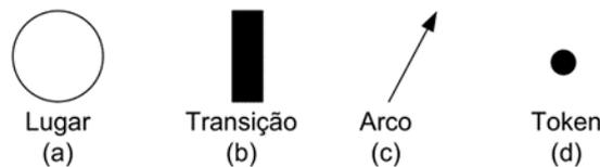
Figura 10 – Elementos de uma rede de Petri.
