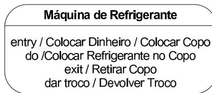
**Figura 4.4:** Exemplo de transição interna.
