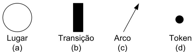
**Figura 2.8:** Elementos de uma rede de Petri.
