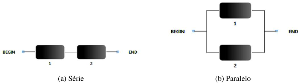
Figura 2.8: Diagrama de Blocos de Confiabilidade
