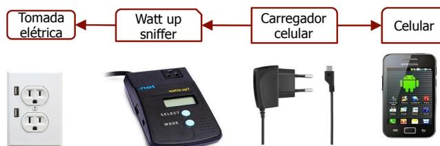
**Figura B.1:** Test-bed de medição de energia com Watts up.
