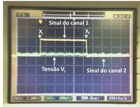
**Figura 4.18:** Sinais capturados pelo osciloscópio durante uma medição.
