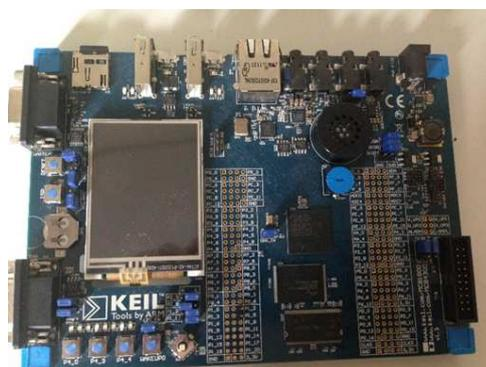
**Figura 7.8:** Placa de desenvolvimento MCB4357, que foi adotada para implementar o protótipo do *SHOUTcast player*.
