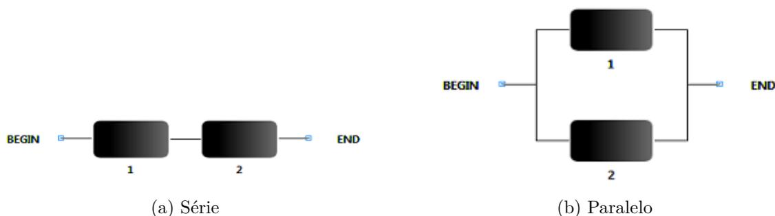
Figura 7 – Diagrama de Blocos de Confiabilidade
