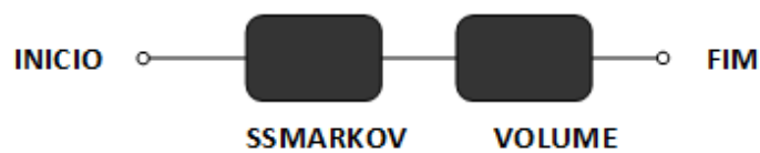
Figura 7.7: Modelo RBD para sistema streaming de vídeo
