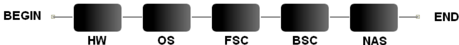
Modelo RBD para o subsistema Storage Manager (SM)
